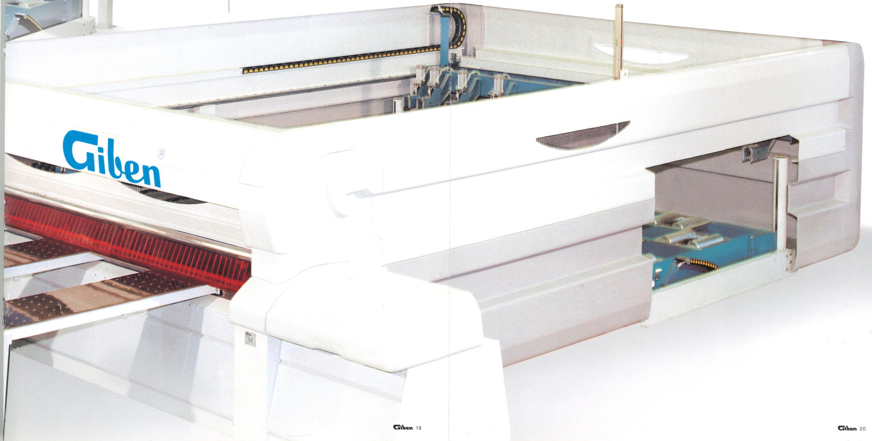
**Pousseur automatique** avec guides supérieurs latéraux, équipé de pinces pneumatiques. Les pinces du pousseur, en acier, flottantes avec double mors inférieurs escamotables, maintiennent le paquet bloqué pendant tout le cycle de coupe jusqu'à la dernière coupe de rafraîchissement.
