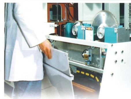
Carters latéraux de forme et matériaux spéciaux, pour diminuer les bruits: permettant entre autre l'accessibilité maximale à toutes les parties de la machine.
