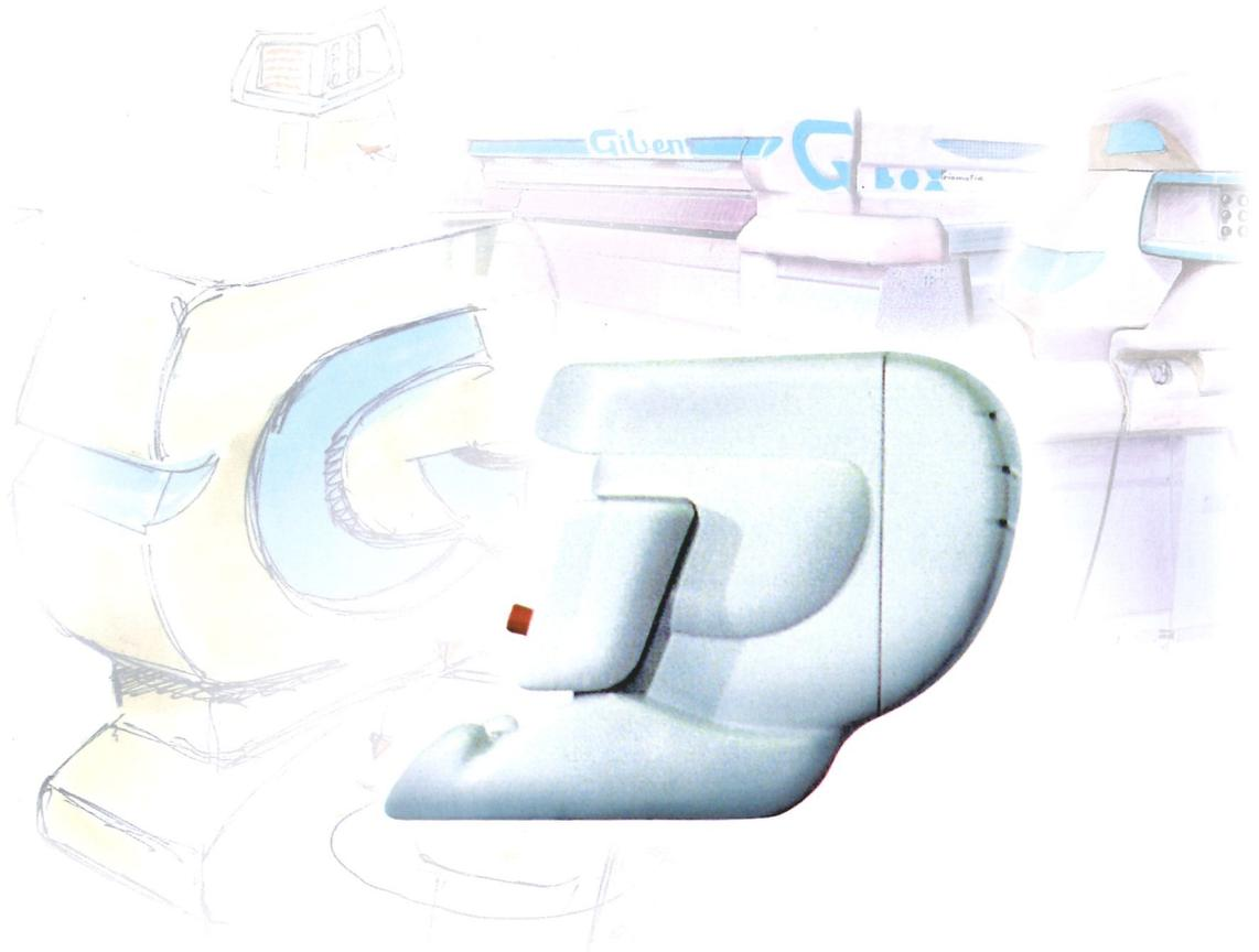
**Chariot porte-lames** et géométrie du système de guidage selon une configuration triangulaire. Ce principe de construction, appliqué depuis plus de 30 ans sur tous les modèles GIBEN, garantit une rigidité et une stabilité maximales.
